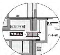
基礎免震建物のビルト構造断面図（一般的参考）
